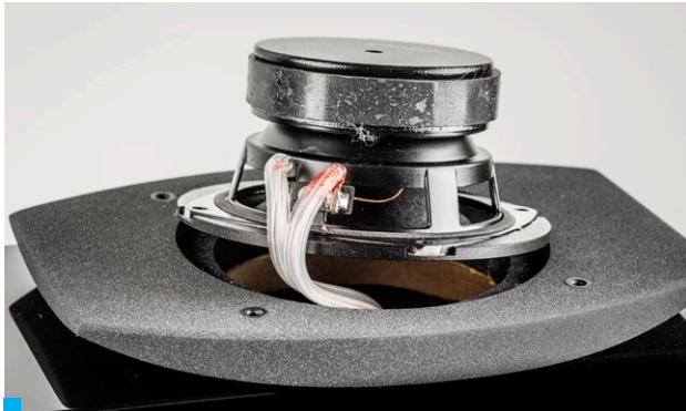
Przetwornik szerokopasmowy ma spory układ magnetyczny, cewka nie ma dodatkowej wentylacji pod dolnym resemem. Głośnik niskotonowy to konstrukcja Seasa.
